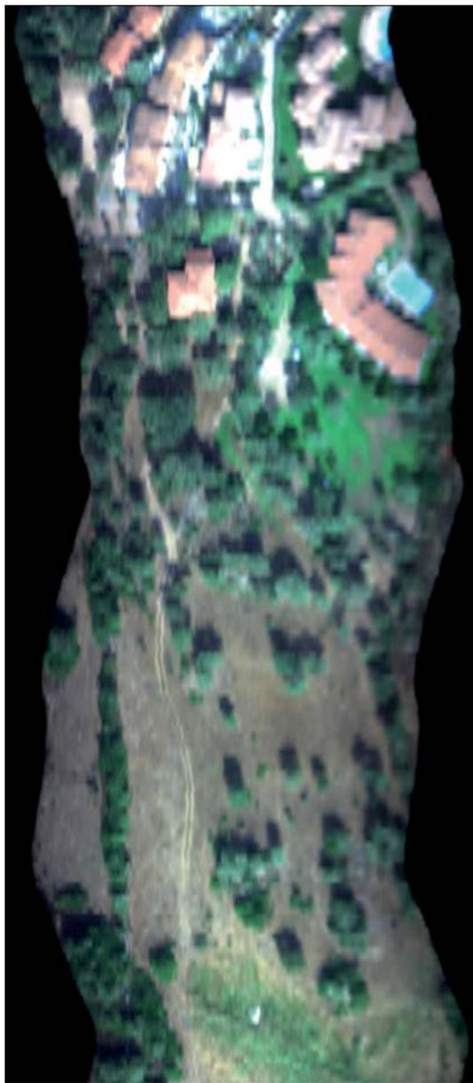
*Figura 7. Cubo iperspettrale visualizzato in RGB utilizzando le immagini relative alle bande 700 nm R, 600 (G) e 500 (B)*
