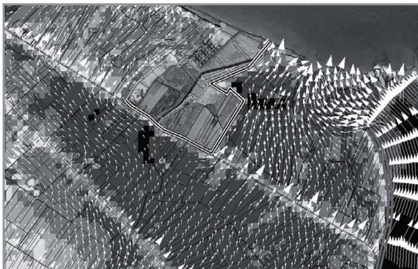
Figura 9 - Simulazione idraulica relativa alla presenza dell'argine in foce
