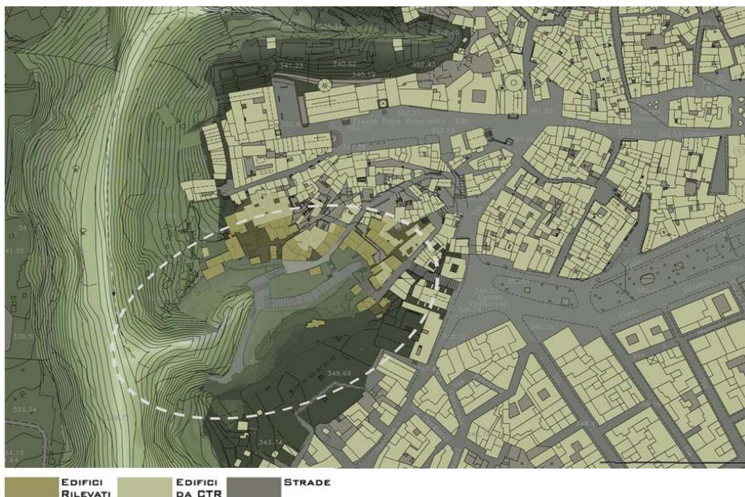
Fig. 5 – Planimetria realizzata integrando la carta tecnica regionale con i dati elaborati dal rilievo laser scanner. In evidenza l'area di studio.
