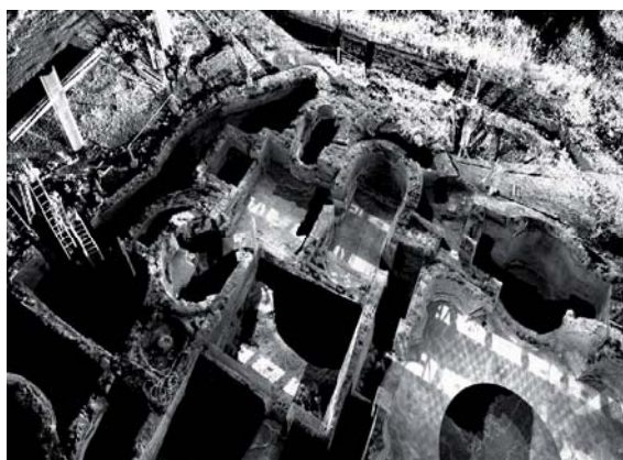
Figura 4 – Modello 3D (Laser scanner) in visualizzazione fotorealistica con l'applicazione dei valori RGB dei punti
