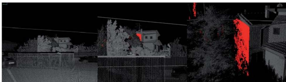
Figura 3 – Test di acquisizione del VZ-400 in presenza di vegetazione
