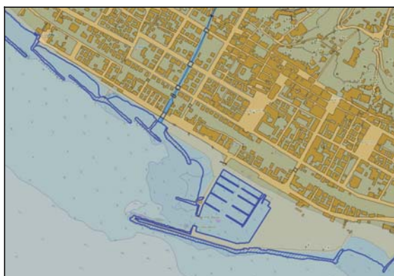
Figura 3 - Confronto della linea di costa del DB topografico (in blu) con la ENC ufficiale
