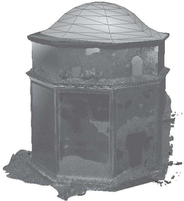
Figura 6: confronto tra il modello per mesh e il modello geometrico
