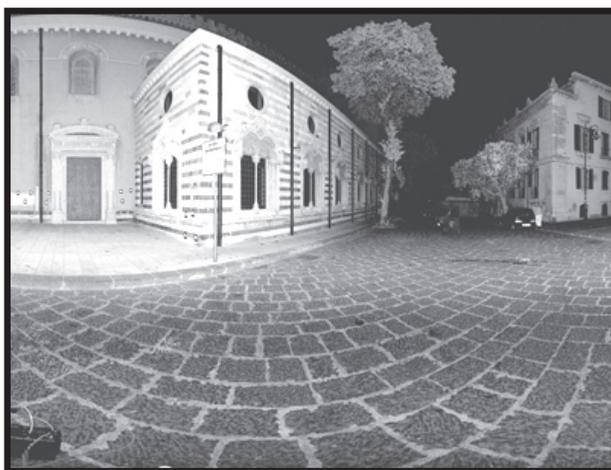
Figura 5 - nuvola di punti acquisita con la scansione B
