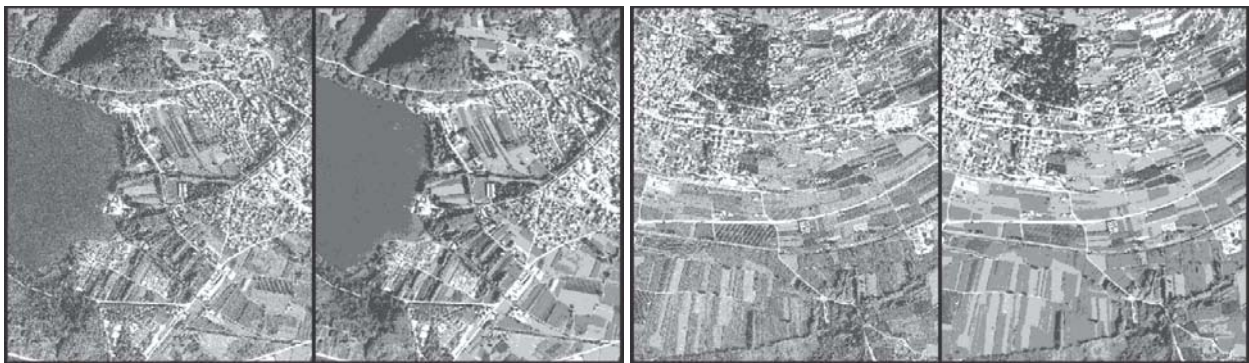
Figura 3 - Classificazione di una ortofoto (1a e 3a immagine) e della versione segmentata della stessa ortofoto (2a e 4a immagine).
