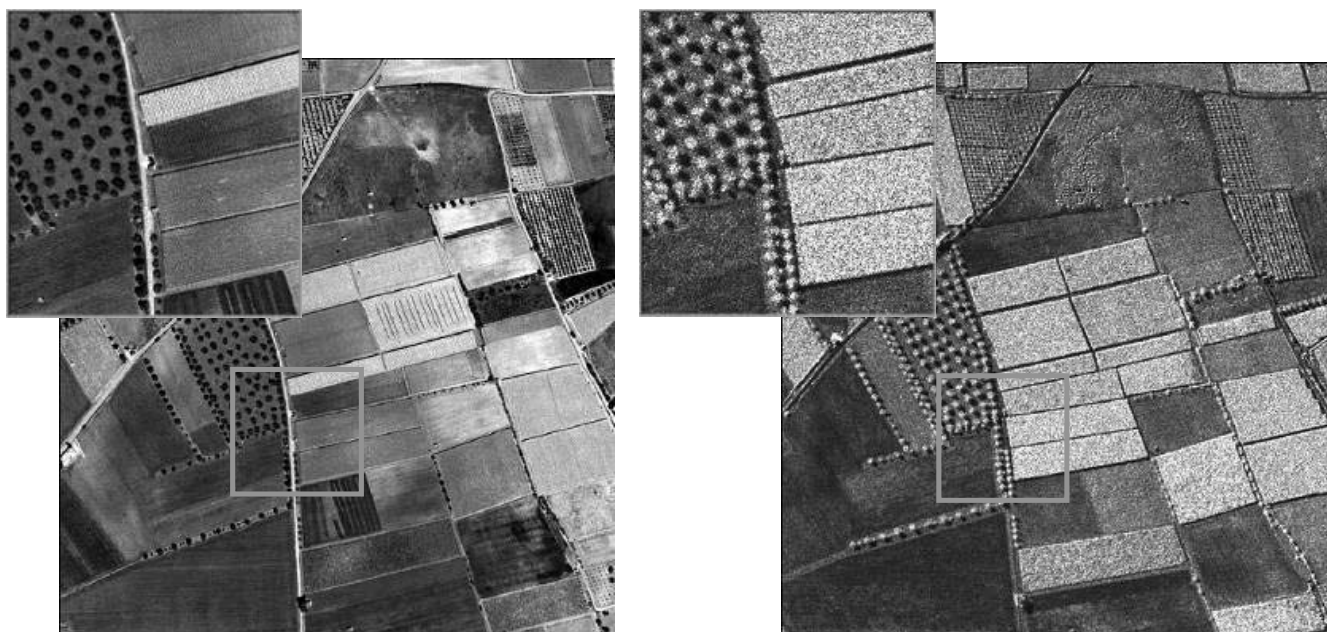
Fig 4 - esempio di confronto tra ortofoto tradizionale e SAR Teleradarsat ad alta risoluzione (0,5m) per l'identificazione delle tematiche agricole, anche in caso di copertura nuvolosa o assenza di luce
