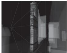
I rilievi e gli aggetti sono ottenuti in fase di rendering utilizzando mappature basate su differenze di toni di grigio (mappe di "bump" e "displacement")<sup>vi</sup>. Le fotografie originarie e le relative mappe di "bump" sono state riproiettate sul modello volumetrico come "tek ures".
