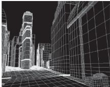
Dalle immagini, senza alcuna informazione metrica, ma soltanto attraverso passaggi di geometria proiettiva, si sono ricostruiti i punti di presa e le caratteristiche di focale. Da qui infine, mettendo in coerenza le diverse immagini, si è arrivati a un modello della volumetria della piazza.
