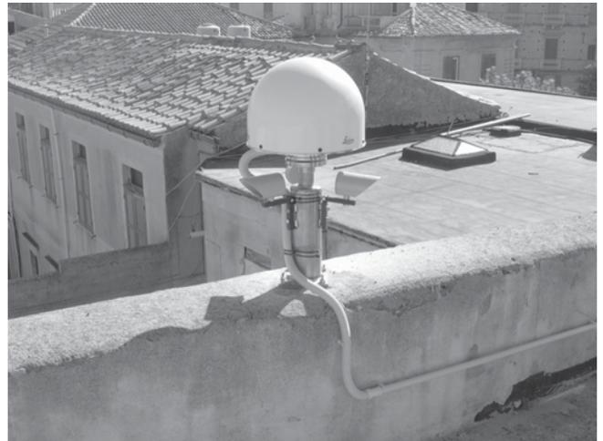
*Antenne geodetiche utilizzate per la rete di stazioni permanenti GPS della Regione Calabria*
