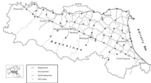
Figura 1 – Rete regionale di livellazione geometrica e GPS per il controllo dei movimenti verticali del suolo nella Pianura Padana
