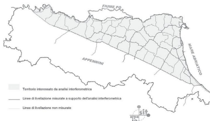
Fig. 2 – Area interessata dall'analisi interferometrica PSInSAR<sup>TM</sup> sovrapposta alla rete di livellazione geometrica misurata nel 2005.
