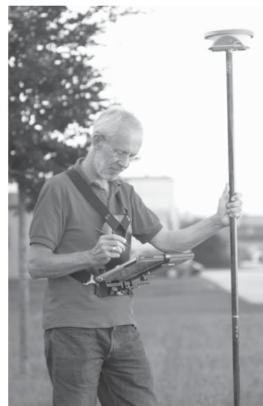
Figura 1 – Operatore in fase di rilievo con GPS e Tablet PC
