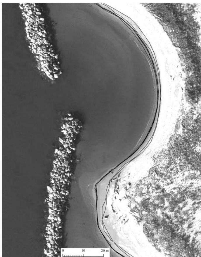
*Figura 5 - Linee d'acqua tracciate da 6 fotointerpreti sulle ortofoto con risoluzione di 20 cm (particolare del tratto studiato).*
