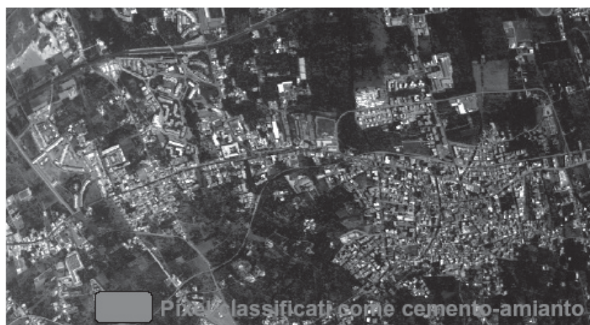
Figura 1 – Risultato della classificazione SAM, in rosso le sole superfici in cemento-amianto
