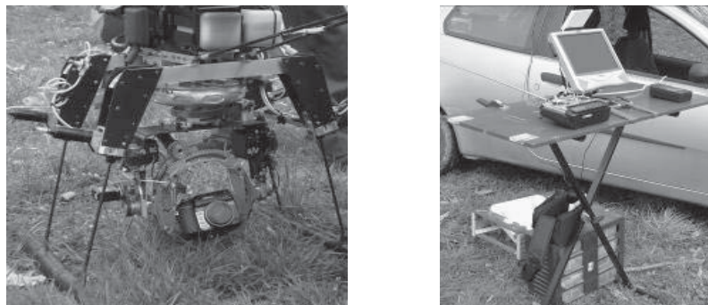
Figura 2 - Supporto per il posizionamento della camera (sinistra) e sistema di controllo a terra per l'acquisizione delle immagini (destra)
