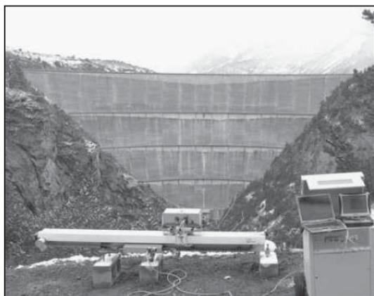
Fig. 1. *IBIS-L* posizionato di fronte al paramento di valle della diga di Cancano
