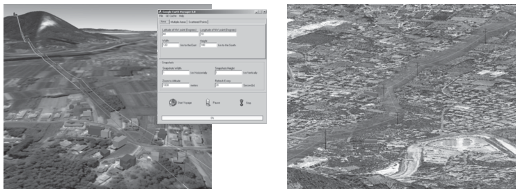
Figura 6 – Visualizzazione dell'indicatore per ciascuna campata e calcolo del campo in corrispondenza degli edifici in ambiente GoogleEarth con la finestra di GEVoyager(a sinistra) e la visualizzazione in ArcScene della superficie di isocampo e del modello 3D dell'edificato.
