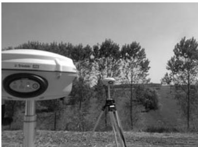
Ricevitore Trimble R6 – radio trasmittente/ricevente integrata
