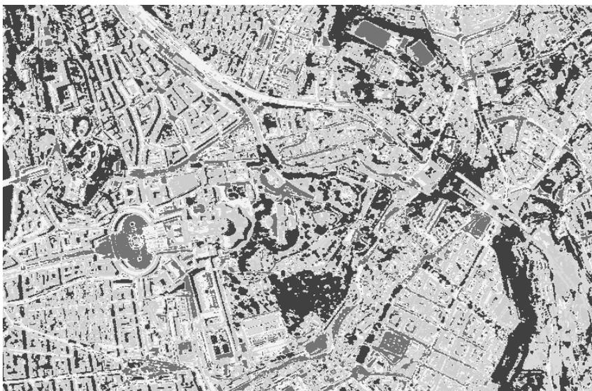
Figura 1 – Roma. Immagine MIVIS visualizzata nel canale 93 corrispondente a 8.2-8.6 micron. Viene descritto il comportamento delle superfici in termini di emissività. In uno slicing su 6 livelli di colore si caratterizzano i valori di temperature al suolo registrati dal sensore.
