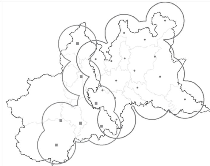
Figura 1: rete di stazioni permanenti GNSS gestita da IREALP
