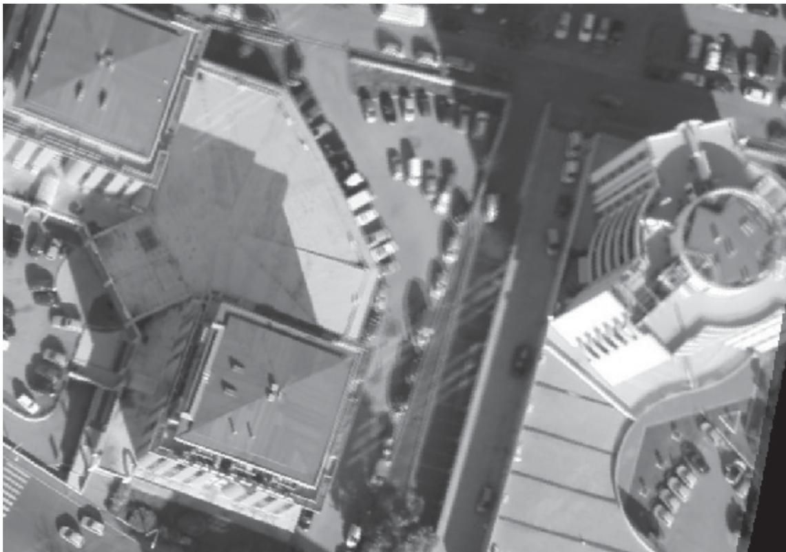
*Fig.1: Ingrandimento di un'area visualizzata in semitrasparenza su 3 ortofoto sovrapposte (ottenute con i 3 software citati nel testo) per mettere in evidenza le differenze geometriche. Come si vede, l'errore di calcolo e' dell'ordine di qualche pixel, non costante sulla superficie dell'immagine. Nell'angolo basso a sinistra dell'area ingrandita non si vedono differenze significative, mentre nella parte centrale si trovano spostamenti visibili.*
