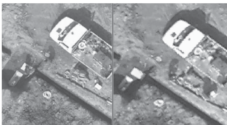
Figura 9 – Esasperazione del confronto fra ortofoto digitale eseguita da 200 e da 400 metri di quota relativa.
