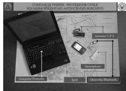
Figura5 -Strumenti utilizzati
