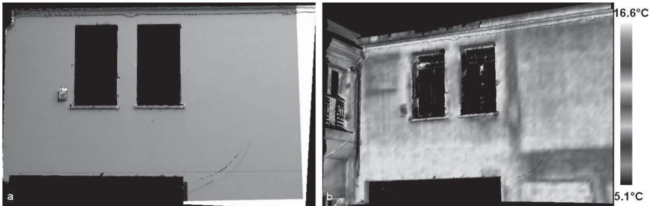
Figura 3 – Texture mapping delle immagini acquisite nel visibile (a) e di quelle termografiche (b) per la parete esterna della muratura analizzata
