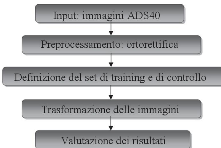
Figura 2 Successione delle fasi impiegate per la classificazione delle immagini ADS40 con il metodo PCA
