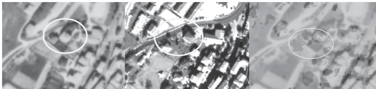
Figura 7 - La stessa area sulle immagini aeree del 1977, sull'immagine satellitare del 2006 e con le variazioni tra i DSM (in rosso positive, in blu negative)
