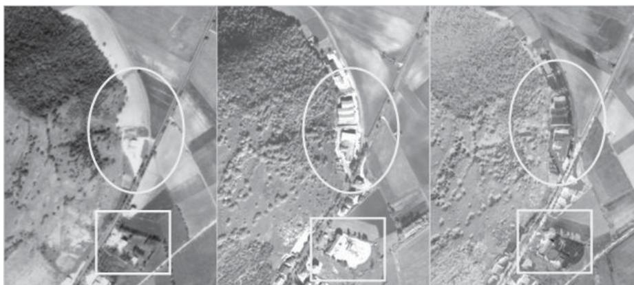
Figura 2 - partendo da sinistra: 1977, 2006, change detection: presenza di nuovi edifici
