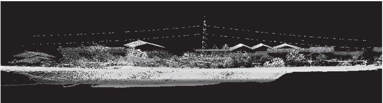
Figura 1 – Le linee aeree rilevate dal LiDAR sono facilmente identificabili e selezionabili durante l'analisi del DSM prodotto dalla scansione.
