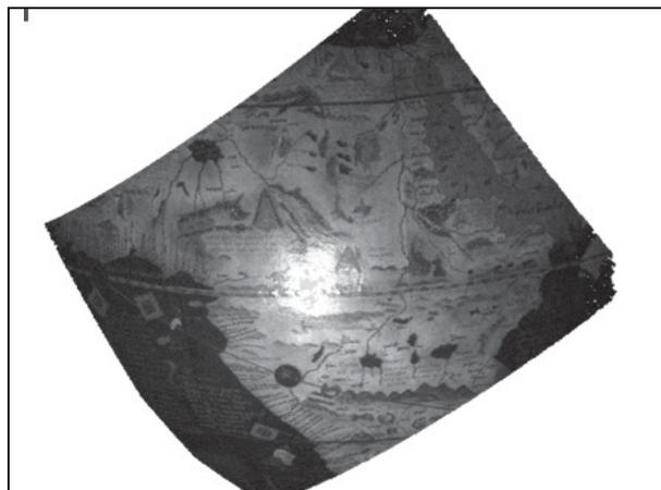
Fig. 3 Acquisizione laser del globo di Coronelli e materializzazione del sistema di riferimento
