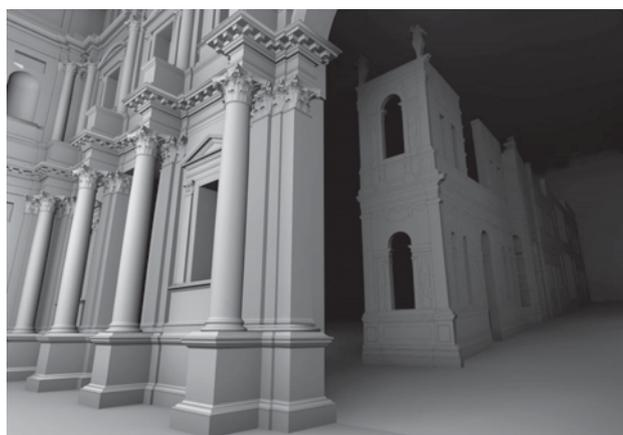
*Fig.1* Teatro Olimpico di Vicenza di Andrea Palladio. *Fig.2* Esempio di modello digitale ottenuto da dati laser scanning e fotogrammetria digitale. Rilevo e rappresentazione eseguiti da SAT-SURVEY, collaudatore: prof. Francesco Guerra
