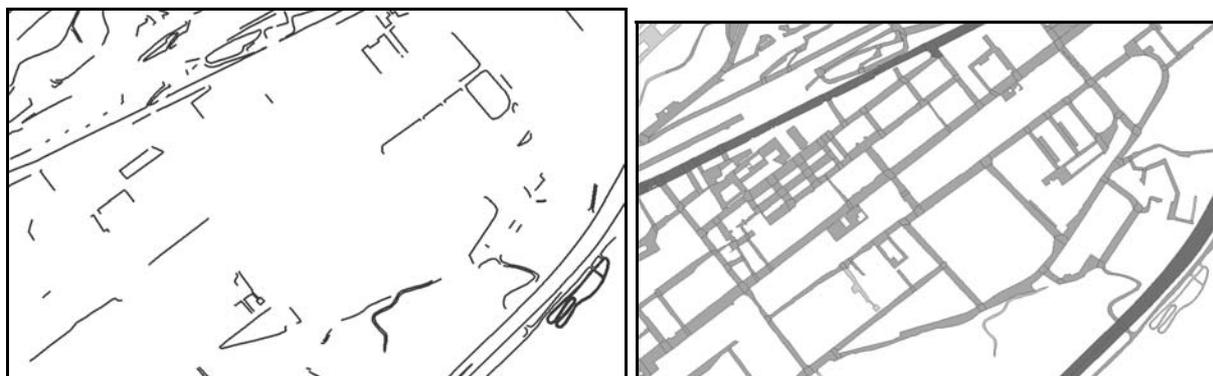
*Figura 5 - a) La situazione originale degli archi stradali, b) La ricostruzione finale delle aree stradali*
