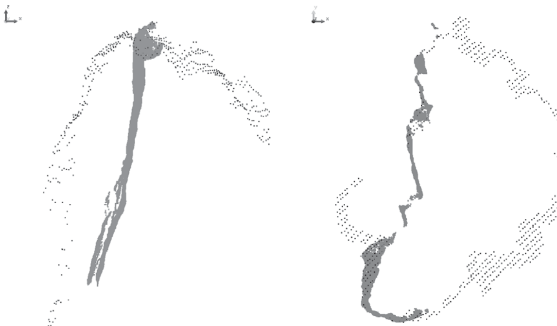
Figura 2 - Confronto tra le nuvole di punti da rilievo aereo (in nero) pre-evento, e terrestre (in rosso) post evento. Sinistra: sezione verticale della vista di Cima Una, con piano normale alla direzione Nord. Destra: sezione orizzontale delle nuvole di punti, in corrispondenza di quota 2.650 m (spessore della sezione, usato per la rappresentazione: 10 m).
