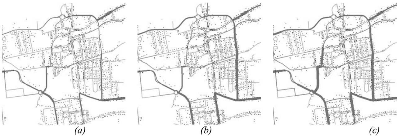
Figura 2 – Risultati della simulazione del traffico per un'area di interesse contenente un centro storico con limitato transito veicoli consentito. Lo spessore delle linee rappresenta in scala non lineare il flusso veicolare ottenuto con le tre tipologie di distribuzione: a capacità infinita (a), a capacità omogenea (b) e a capacità basata sui civici (c).
