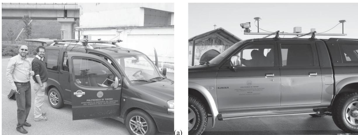
Figura 1: Il sistema a basso costo GNSS/INS progettato al Politecnico di Torino (DITAG) nella sua configurazione attuale (a) e nella configurazione adottata durante il test a Morozzo (CN): si noti l'adattabilità del sistema realizzato a veicoli differenti
