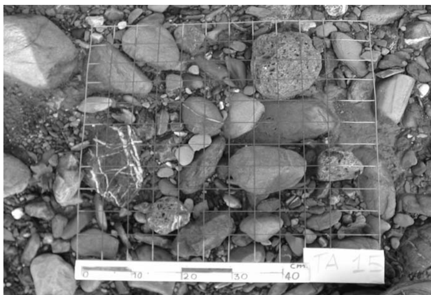
Figura 1- Rete metallica a maglia quadrata utilizzate nelle misure di campagna
