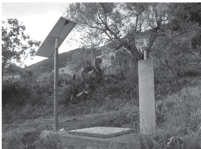
Figura 2 – Rete di Lago: monumentazione di una stazione GPS in continuo
