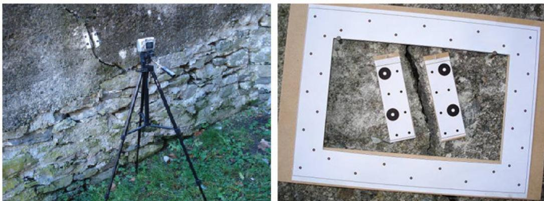
Figura 3 – L’acquisizione di un fotogramma e i target dei supporti e della cornice
