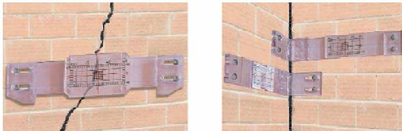
Figura 1 – I fessurimetri lineare ed angolare Fes-TT1 e Fes-TT2 TECNIX
