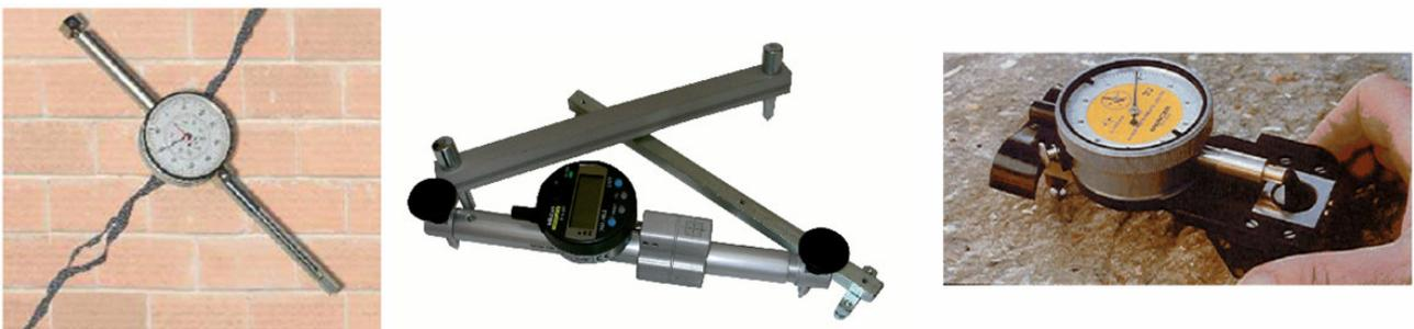
Figura 2 – Il crepometro TECNIX Cre-C1 e i deformometri EMME 100 e DEMEC
