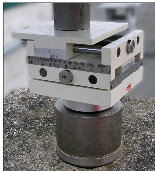
Fig. 5 – Antenna choke-ring montata su slitta nel sito UPG2; a destra, particolare della slitta bidirezionale
