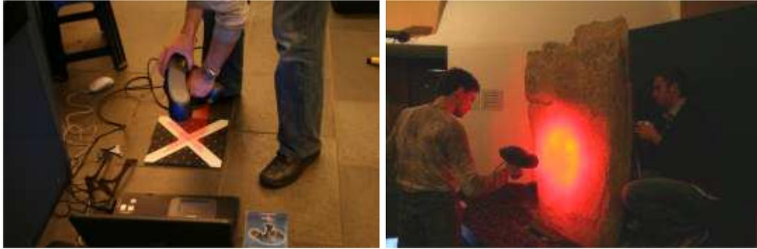
Figura 4 – Calibrazione geometrica (a sinistra) e calibrazione radiometrica (a destra) dello strumento
