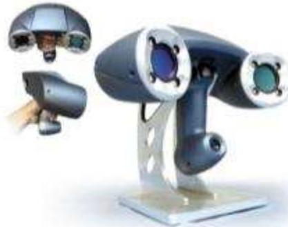
Figura 2 – L'unità di acquisizione HandyScan3D (980 g, 160 x 260 x 210 mm, ISO accuracy: 20  $\mu$ m + 0.2L/1000)
