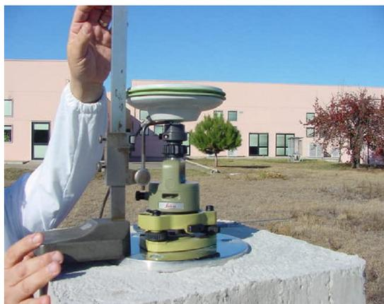
Figura 2 – Operazioni di misura  $h_{antenna}$
