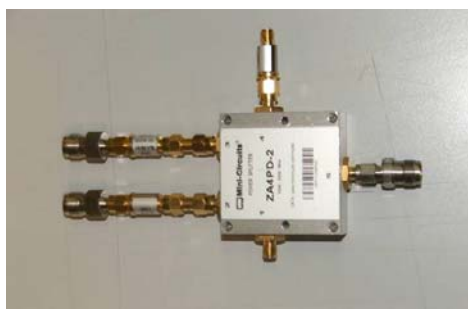
Figura 2: Splitter impiegato nelle prove per collegare tre ricevitori ad una sola antenna
