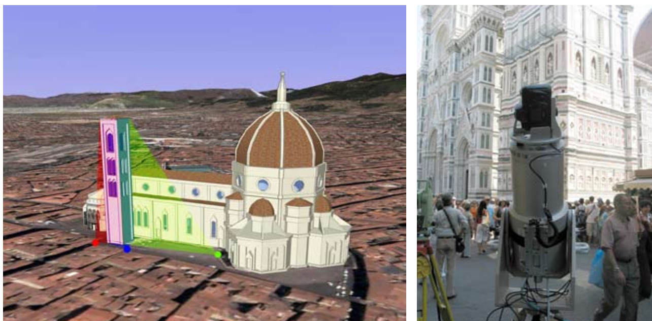
Figura 3 – Posizioni di acquisizione delle scansioni laser
