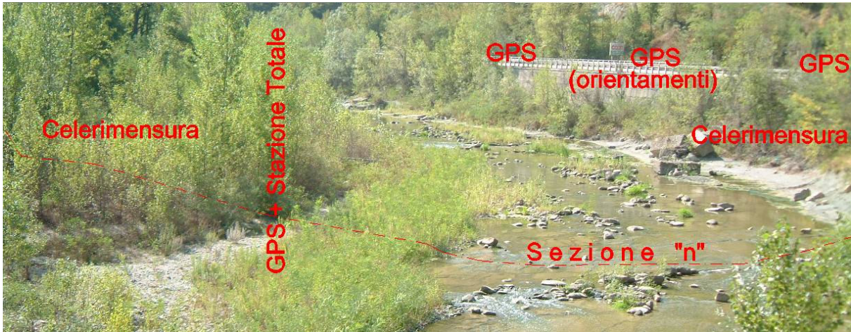
Figura 3 – Sezione fluviale rilevata con metodologia Trimble Integrated Surveying.
