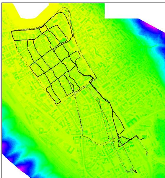
*Fig. 1: esempio di percorso nella città di Como. Linea continua: condizione di scarsa visibilità del cielo; linea tratteggiata condizione di buona visibilità del cielo.*
