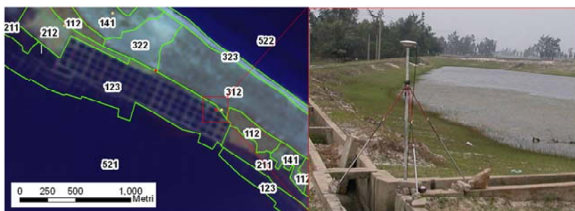
figura 3: esempio di come si presenta la classe 123 in un'immagine Spot5 FCC RGB 342; a destra, rilievo delle coordinate GPS di un punto utilizzato nel processo di ortorettifica.
