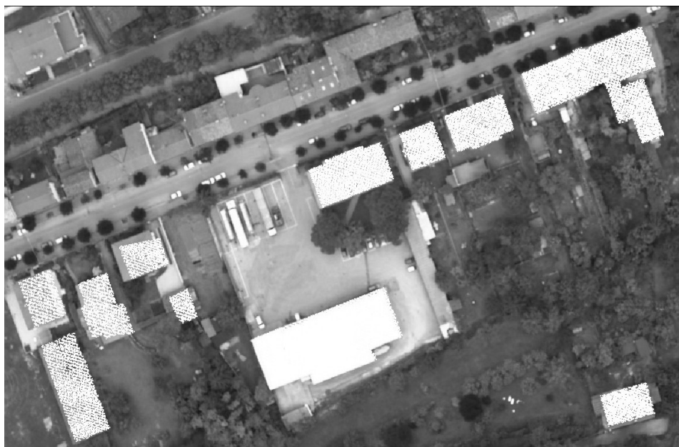
Figura 1 – Dataset di esempio con ortofoto e punti laser ricadenti sugli edifici classificati utilizzando il software commerciale TerraScan™ della Terrasolid (Terrasolid, 2001).
