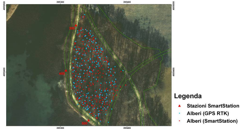
Figura 6. Confronto tra rilievo GPS RTK e rilievo SmartStation sulla particella 69.
