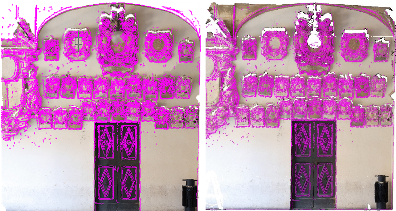
Figura 4 – Texture del prospetto Est generate con il software Z-Map© (sx) e Reconstructor© (dx) con sovrapposizione delle linee di discontinuità ottenute dal modello globale
