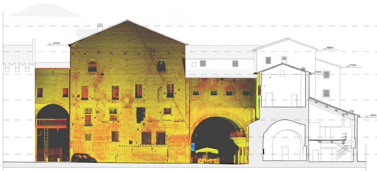
Figura 1: Un prospetto del Palazzo del Podestà. Sovrapposizione del disegno CAD con nuvola di punti.
