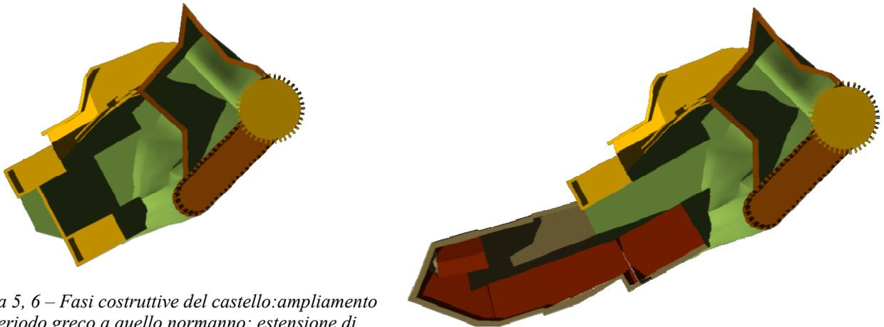
Figura 5, 6 – Fasi costruttive del castello: ampliamento dal periodo greco a quello normanno; estensione di epoca svevo- aragonese.
