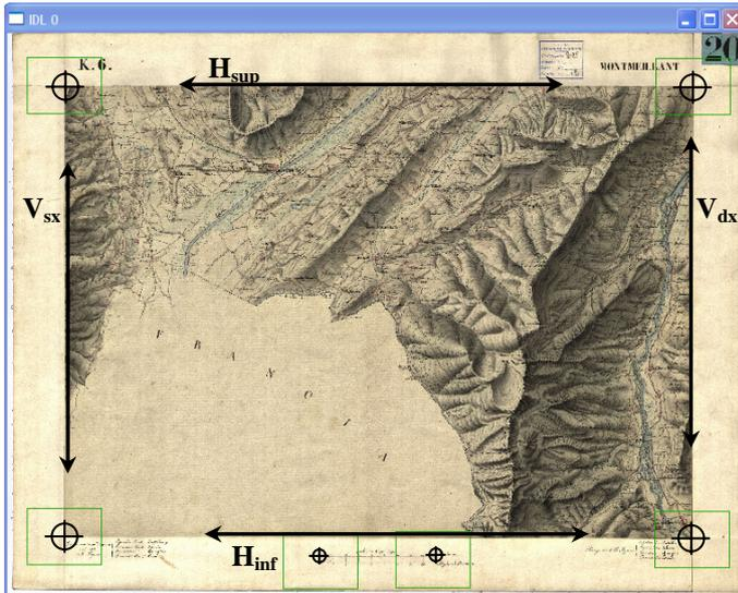
Figura 2 – Foglio campione (K.6) sul quale sono evidenziati i 6 punti collimati per le valutazioni dimensionali e la denominazione adottata per la misura dei lati.
